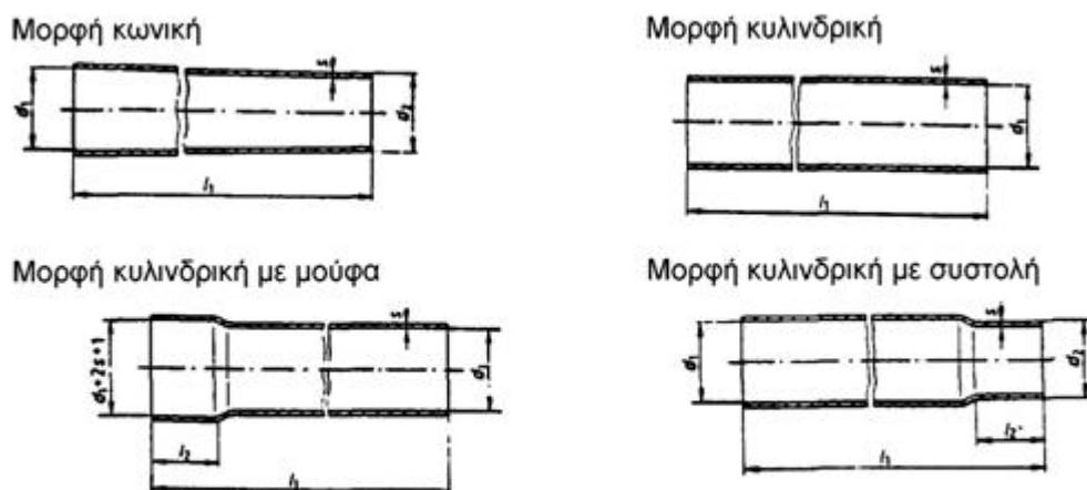
Εικ.11.5 Σωλήνες καπναγωγών από μέταλλο
